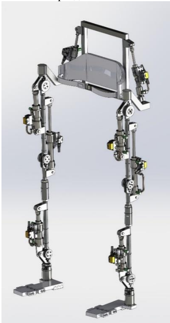
Сурет 2.3 – ЭГҚЖ бар экзоскелеттің ОМ жалпы түрінің 3D моделі
